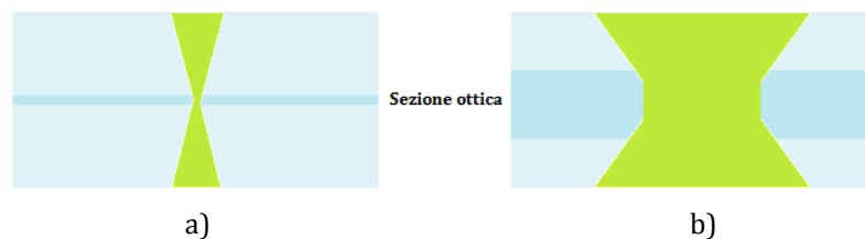
Figura 3.2: Confronto delle dimensioni del volume del campione illuminato da un obiettivo con stessa apertura numerica nel caso di microscopio tradizionale a) e microscopio confocale b).
